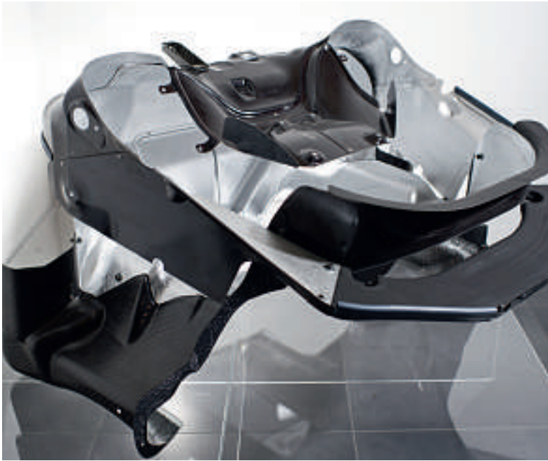
Composites für den Hochtemperaturbereich: Das Hitzeschild für den neuen Porsche 918 Spyder besitzt eine Temperaturtoleranz bis 750 °C. (Bild: Connova)
