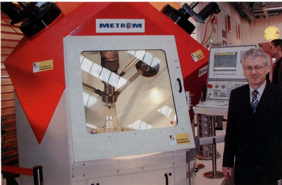
Dr.-Ing. Michael Schwaar sieht seine Kompakt-Maschine mit Parallelkinematik im »Raumkapsel«-Format für die Fünfseiten-Fertigung im Modell-, Werkzeug- und Formenbau.
